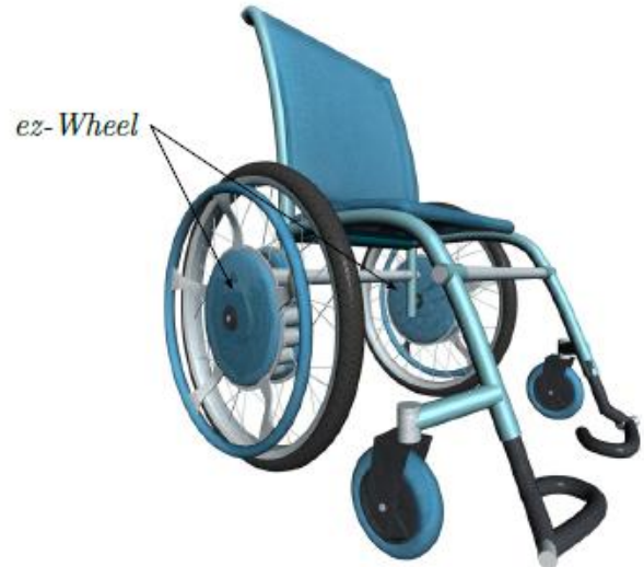
Figure 3 – Prototype de fauteuil roulant équipé de deux ez-Wheel
