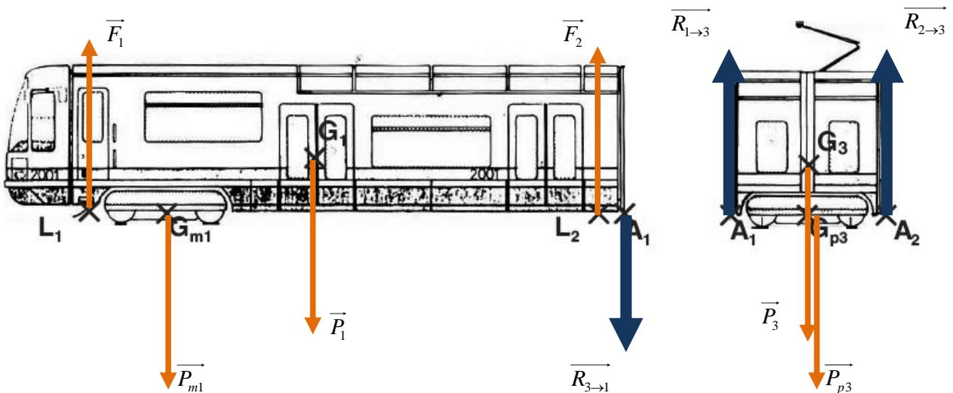
**Q3 :** Exprimer les actions mécaniques des colonnes de levage en L1 et L2, en fonction des grandeurs géométriques et des poids des différents éléments du tramway. Calculer ces actions mécaniques. (Chacune de ces actions est supportée identiquement par deux colonnes).
