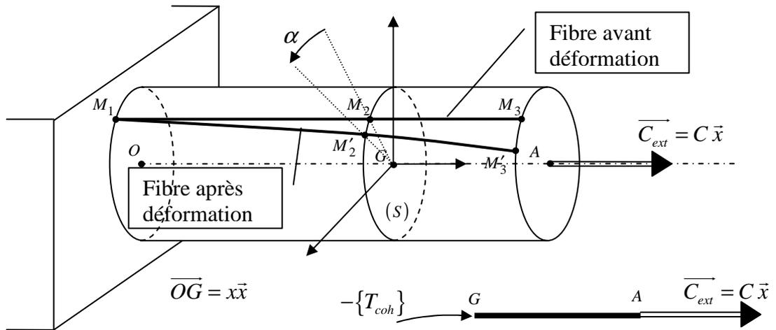
Le calcul du torseur de cohésion, en conservant la partie droite en G, permet de constater :
