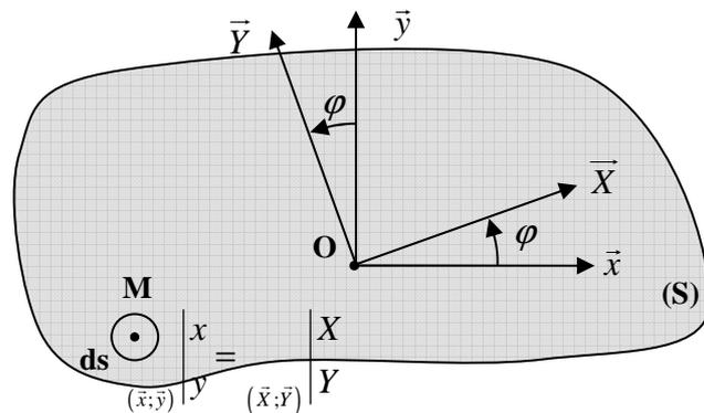
$$\vec{OM} = x\vec{x} + y\vec{y} = X\vec{X} + Y\vec{Y}$$
