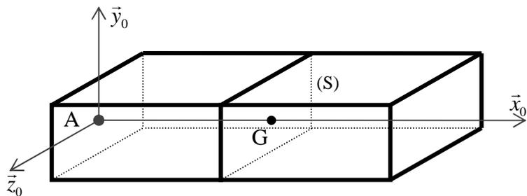
On repère une section droite (S) de la poutre (E) par la quantité :  $\vec{AG} = x\vec{x}_0$
