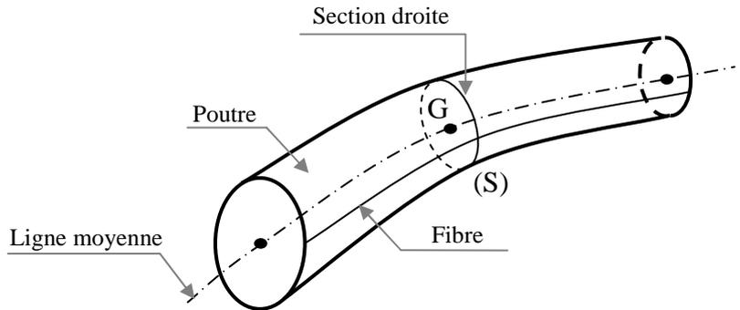
La ligne moyenne est droite pour les poutres droites, elle est très élancée, c'est-à-dire qu'elle possède une **grande longueur par rapport à ses dimensions transversales**. La surface plane (S) est appelée **section droite**.
