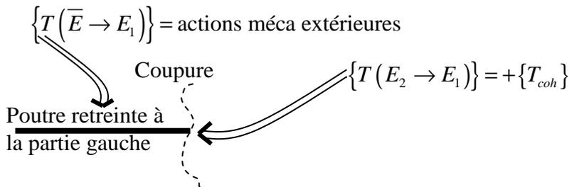
Ainsi :  $\{T(\bar{E} \rightarrow E_1)\} + \{T_{\text{cohésion}}\} = \begin{Bmatrix} \vec{0} \\ \vec{0} \end{Bmatrix}$  soit  $\{T_{\text{cohésion}}\} = - \{T(\bar{E} \rightarrow E_1)\}$
