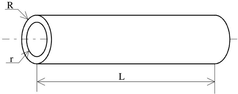
Cylindre creux de longueur L, de rayon extérieur R, de rayon intérieur r et de masse m avec :
