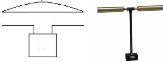
Fig. 9 – Antenne demi-onde : schéma et réalisation.
