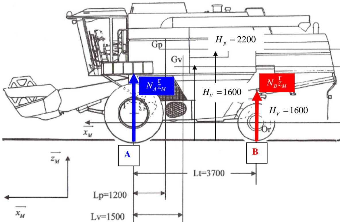
Le véhicule étant considéré plein, on raisonne à partir d'une masse  $M_p = 20,6$  tonnes située en  $G_p$ . On paramètre le problème de statique avec les réactions sur les roues avant (en A), noté  $N_A$ , et sur les roues arrières, notés  $N_B$ , comme sur la figure ci-dessus. Reste à déterminer  $N_A$  et  $N_B$ , à les
