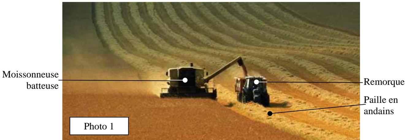
Le céréalier, installé dans la cabine de conduite, parcourt la surface du champ par bandes parallèles de la largeur de la coupe de la moissonneuse–batteuse. La céréale est coupée puis battue, c'est-à-dire que le grain est séparé de son enveloppe (la balle) et de la paille. Nettoyés des impuretés, les grains sont transvasés dans la remorque qui roule à coté de la moissonneuse batteuse. La paille et les balles sont déposées, en andains, sur les chaumes.
