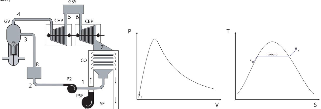
Fig. 3. - Vues schématiques des circuits secondaires considérés et diagrammes correspondants.
