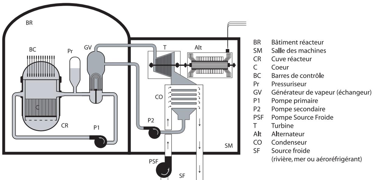
Fig. 1. - Configuration générale d'une tranche nucléaire type réacteur à eau sous pression
