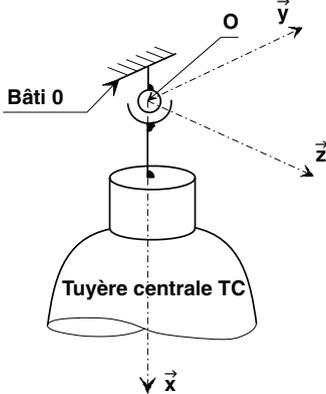
**Figure 1.8 : solution avec une liaison type Cardan**
