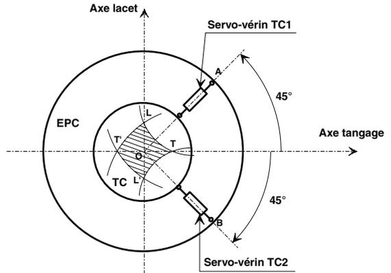
Une étude cinématique de l'ensemble tuyère centrale **TC** – tiges de servo-vérins – corps de servo-vérins – bâti **0** fait apparaître un système d'équations de rang  $r_c = 12$ , quelle que soit la solution retenue pour la liaison tuyère – bâti **0**.
