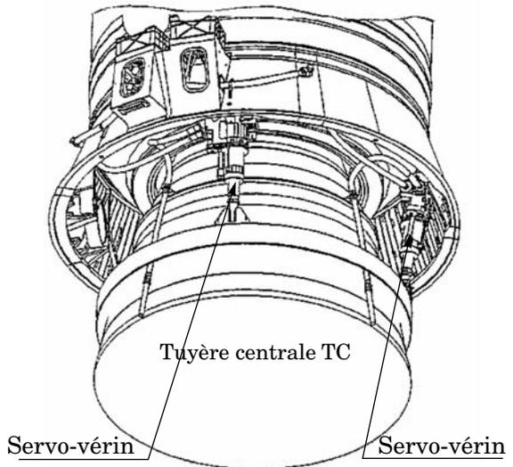
Pour orienter les tuyères autour des directions  $\vec{y}$  (axe de tangage) et  $\vec{z}$  (axe de lacet) on utilise l'élongation de servo-vérins placés dans des plans bissecteurs aux plans  $(\vec{x}, \vec{z})$  et  $(\vec{x}, \vec{y})$ . La figure 1.2. définit les axes de tangage et de lacet, la figure 1.3. définit les plans bissecteurs aux plans  $(\vec{x}, \vec{z})$  et  $(\vec{x}, \vec{y})$ , la figure 1.4. montre l'implantation des servo-vérins pour la tuyère centrale TC.
