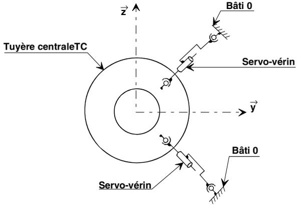
**Figure 1.2 : axes de tangage, de lacet et de roulis**
