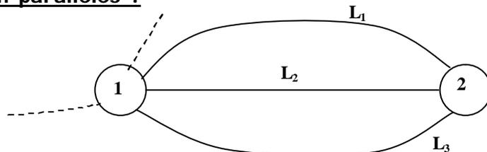
Rechercher la **liaison équivalente de la mise en parallèle des liaisons  $L_1$ ,  $L_2$  et  $L_3$**  revient à **chercher à avoir une liaison  $L_{eq}$**  telle que le graphe des liaisons soit équivalent à celui-ci :
