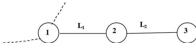
Rechercher la **liaison équivalente de la mise en série des liaisons  $L_1$  et  $L_2$**  revient à **chercher à avoir une liaison  $L_{eq}$**  telle que le graphe des liaisons soit équivalent à celui-ci :
