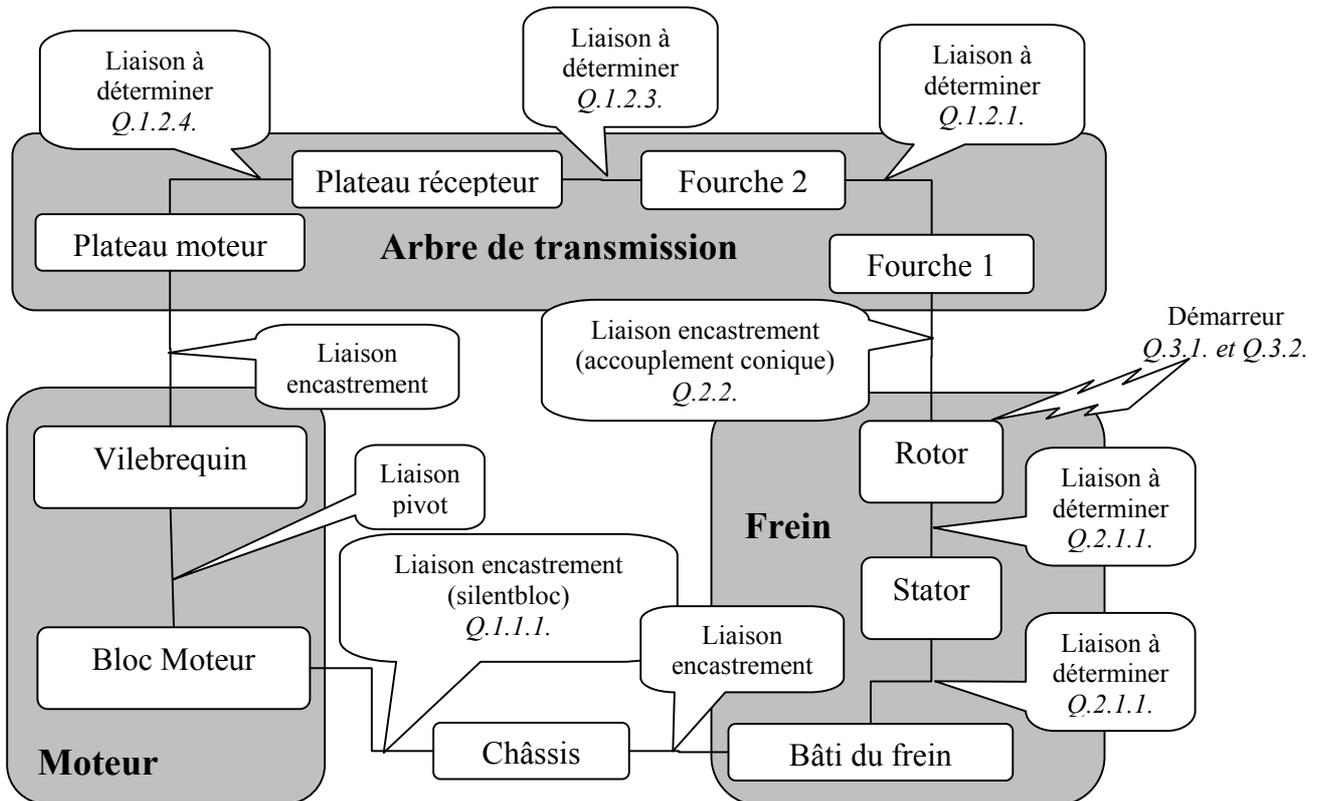
L'objectif de l'étude consiste en une vérification des performances de la chaîne fermée {Châssis – Moteur – Arbre de transmission – Frein – Châssis} , ci-dessus.
