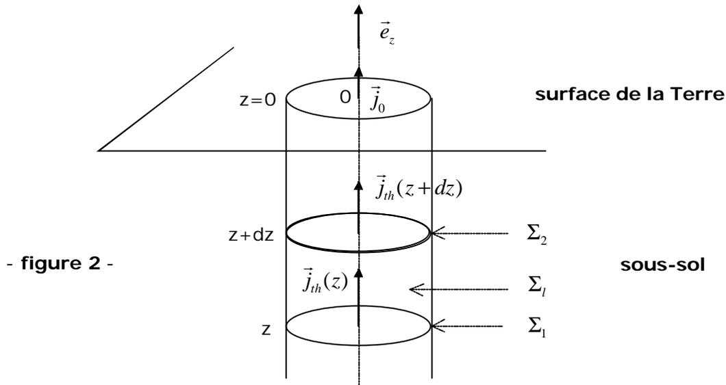
Soient  $dQ_1$  et  $dQ_2$  les quantités de chaleur qui traversent, respectivement, les surfaces  $\Sigma_1$  et  $\Sigma_2$ , entre les instants  $t$  et  $t+dt$ .
