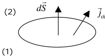
$d\Phi = \vec{j}_{th} \cdot d\vec{S}$  est la puissance thermique algébrique transférée à travers l'élément de surface  $d\vec{S}$ .
