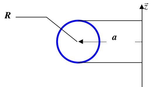
Déterminons le volume du tore engendré par la rotation de la surface rouge d'aire  $A = \pi R^2$  et de centre G au centre de la surface rouge.
