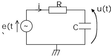
Alimentons un circuit (R,C) par un générateur sinusoidal de fem  $e(t) = E\sqrt{2} \cos \omega t$ .
