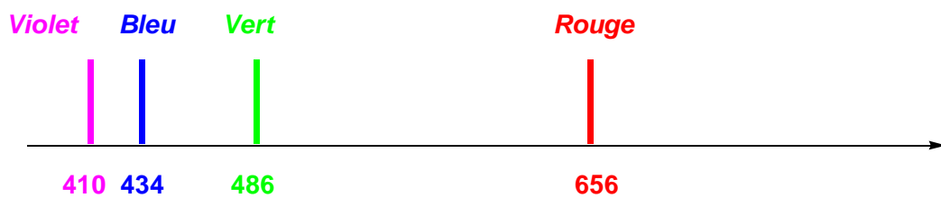
Partie du spectre d'émission d'un atome d'hydrogène dans le visible
