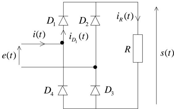
Le pont de 4 diodes ci-contre est alimenté par une tension sinusoïdale:  $e(t) = E\sqrt{2} \sin(\omega t)$
