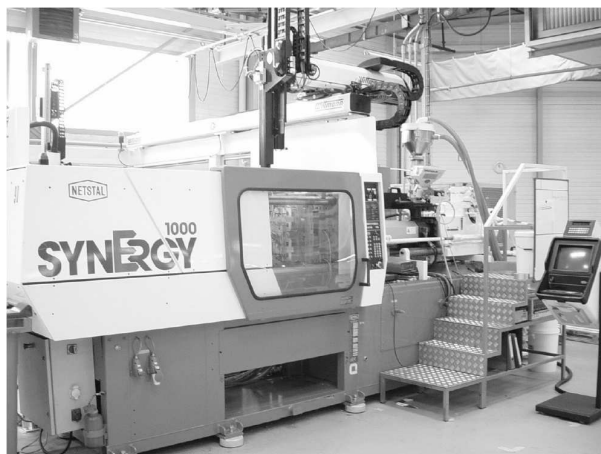
Cellule d'injection a)
